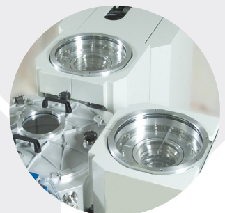
Xactix® CVE modules for vapor XeF 2 etch
